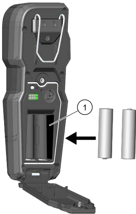
Figura 1. Instalação de baterias do controle remoto
