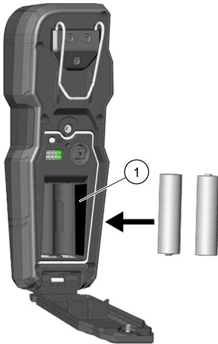
Figura 1. Instalar las pilas del control remoto
