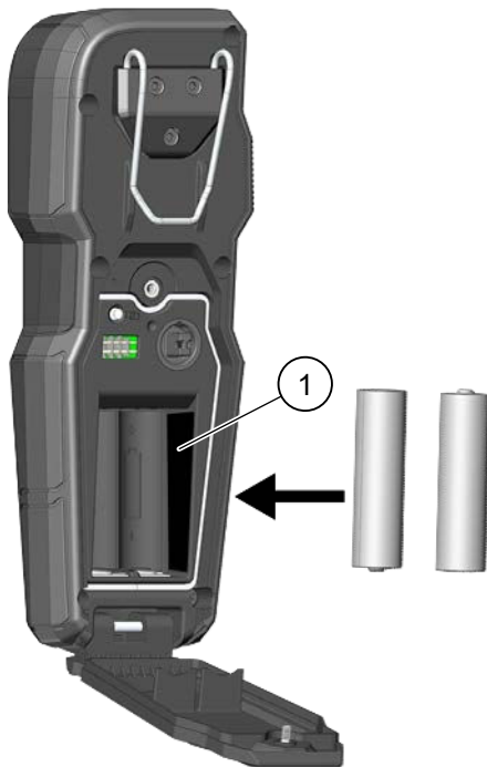
Figure 1. Installation des piles de la télécommande
